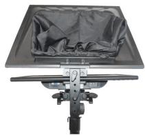
(三)、通过支架连接板连接液晶显示屏支架及反射镜。
