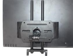
(一)、用三脚架托盘自带的螺丝把液晶显示屏支架固定在三脚架托盘上。
