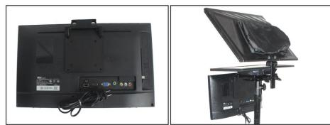
(四)、将自检屏上面的圆孔穿进液晶显示屏支架对应的圆管上。
